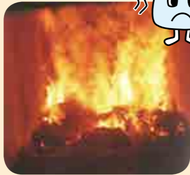
さまざまなごみ質に対応する「ストーカ式焼却炉」で燃焼
