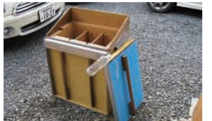
廃材を利用して製作した生ごみたい肥化装置
