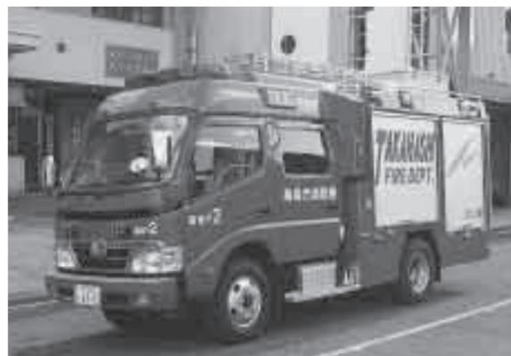
消防署は、平成4年式の消防ポンプ自動車の老朽化に伴い、車両を更新しました。新型車両は総排気量4000ccの四輪駆動車。3級シャシーをベースに、多数のホースが収納でき、消火活動に必要な資機材装備を充
