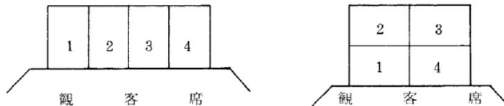
ウ 2以上の放水区域の境界付近において火災が発生した場合に、どちらか一方の放水区域を放水することにより消火が可能であるようにしておくことが必要なため、隣接する放水区域の相互重複は、次によるものとする。ただし、逆止弁方式のものは、点検困難なため用いないこと。◆
