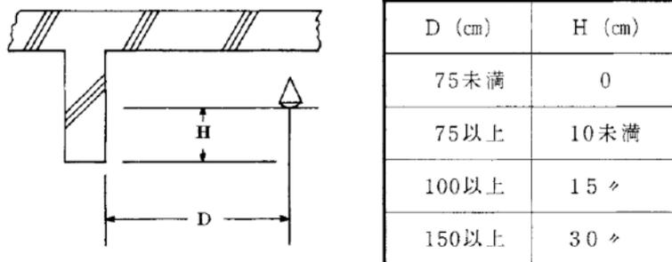
イ ダクト、空調吹出口、配管、吊り金具、照明器具及び火災感知器などで障害物となるものは、ヘッドからの泡放射のさまたげとならないよう、当該ヘッドから横方向に30cm以上離れた位置に設けること。この場合、やむを得ず泡放射の障害となるものが当該ヘッドの位置から横方向30cm以内に設けられる場合には、当該ヘッドを当該泡放射の障害となるものの下端より下方となる位置に設けること。
